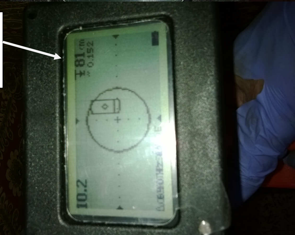
Photo 26: pièce avant à côté du compteur d'eau: cheminement de la décharge principale. Profondeur : +/- 81 cm
