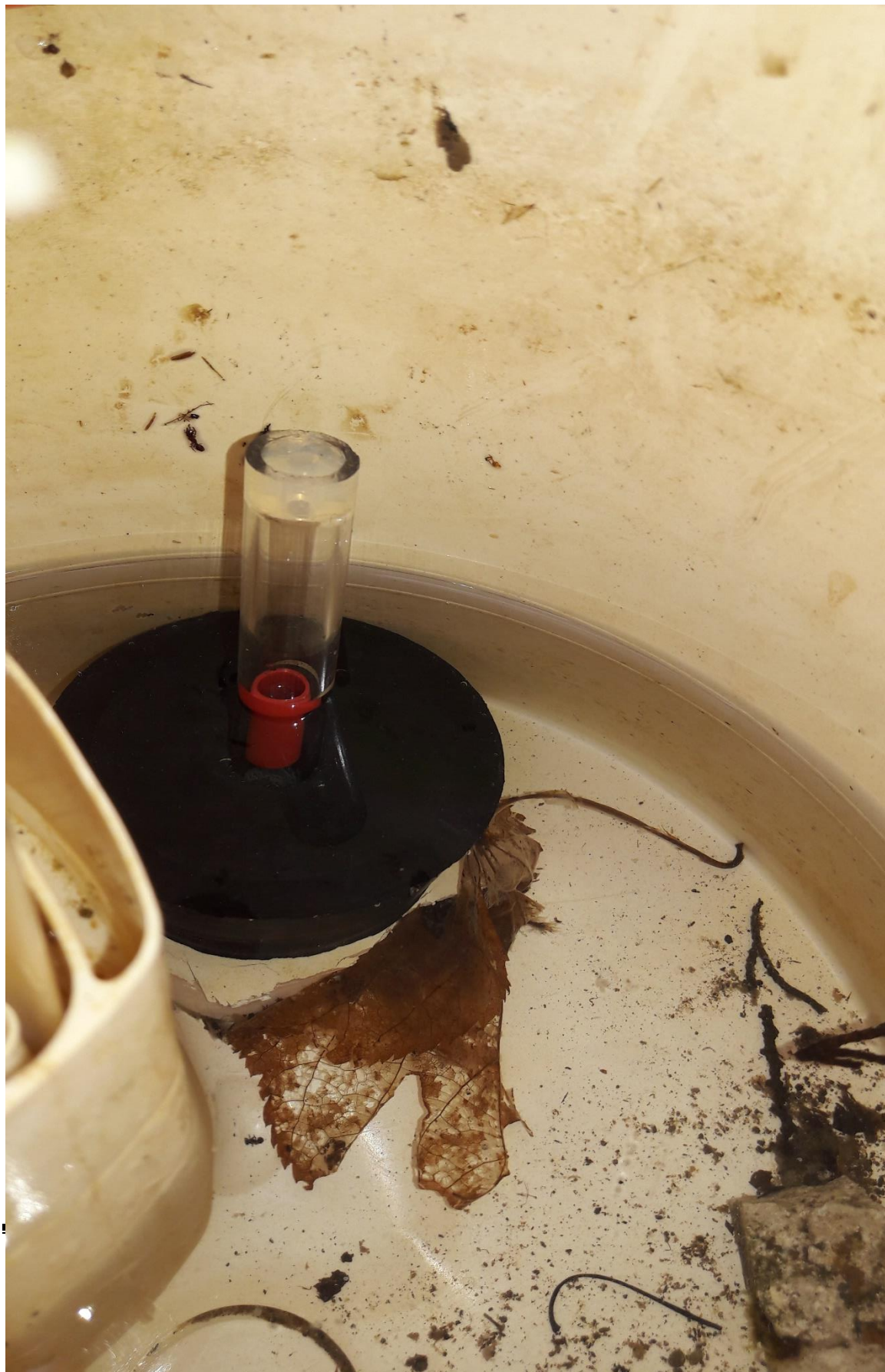
Photo 3: test 1 de dépression sur le remplissage automatique: fin du test, niveau final de l'eau (flotteur en bas de la pipette). Durée du test : 5 min
